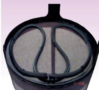
Einsatz im (mbbr) moving bed bio-reactor zur Belüftung einer movingdrum (Unterseite)
